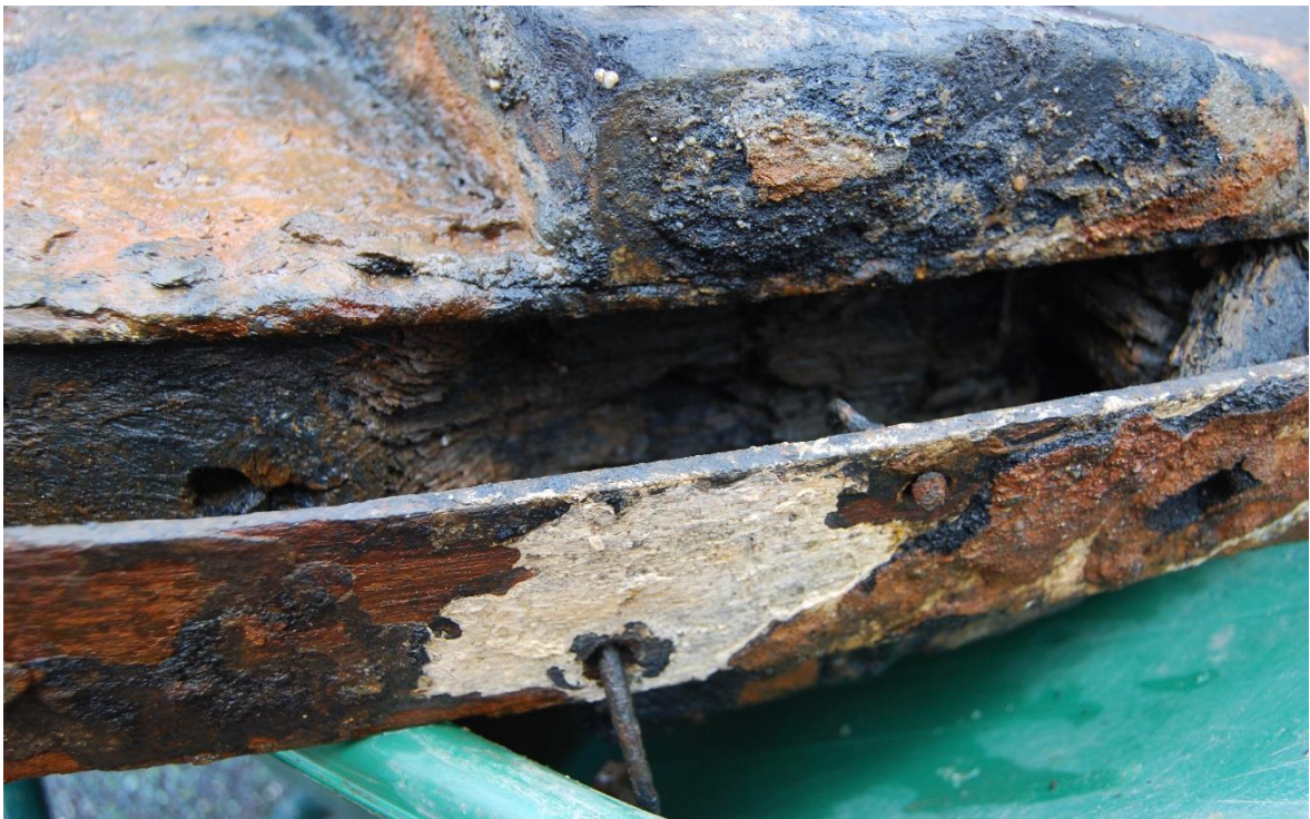
Afbeelding 53 Detailopname van de ijzeren band rondom het roerdeel, de draadnagels en het onderliggende hout. Foto: Vestigia.
